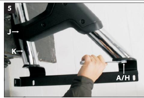
**Afrouxar os parafusos "A" e arruelas lisas "H" que ficam na base, para facilitar montagem ao veículo.**
